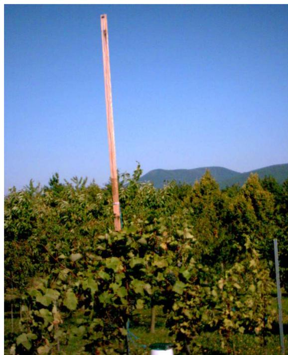
Abb. 3: Antenne zum Sferics-Empfang: einfache Kupferlitze entlang einer Dachlatte
