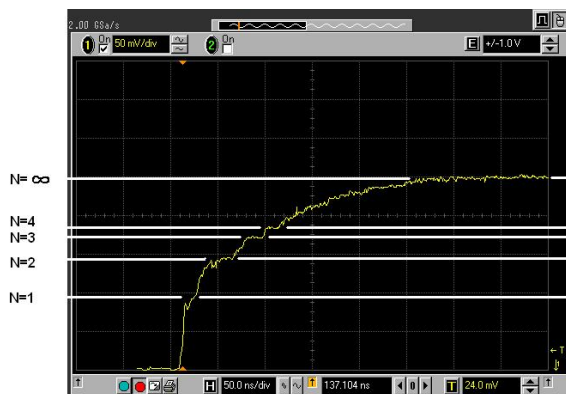
Abb. 7: Golddraht, Durchmesser 0,4 mm, mit Vorwiderstand R_V=100 \Omega , Batterie 1,5 V; mit theoretisch zu erwartenden Plateaus.
