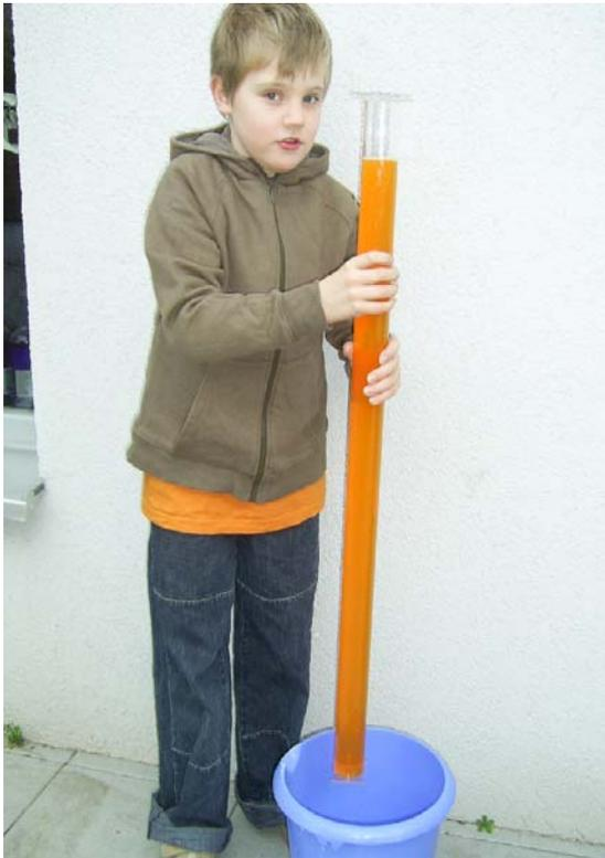
Abb.6: Auch bei einem 1m langen Rohr, welches nur teilweise mit Wasser gefüllt ist, hält die auf der unteren Seite des Rohres nur angedrückte Platte.
