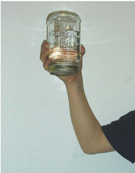
Abb.3: Aus einem umgedrehten Wasserglas, welches mit einem Drahtgeflecht abgedeckt ist, fließt kein Wasser.
