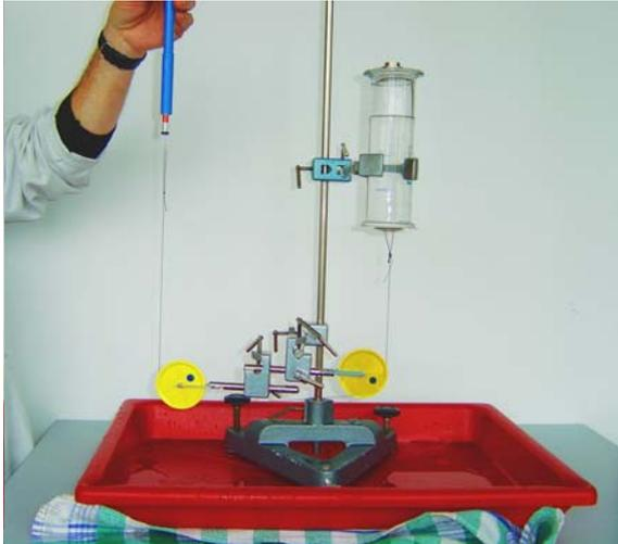
Abb.8: Experimenteller Aufbau zur Messung der Kraft, die die Abdeckplatte an den Messzylinder drückt
