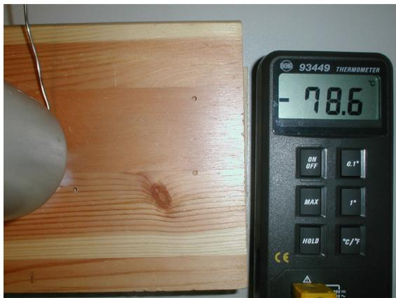
Abb. 5: Abkühlen des Kohlendioxids beim Ausströmen. Die Kartusche (links im Bild) wird mit dem Ventil auf einen Nagel gedrückt, der vorher in ein Brett eingeschlagen wurde. Das ausströmende Kohlendioxid ist sehr kalt. Die Temperatur wurde mit Hilfe eines NiCr-Ni-Thermometers (Metalldraht oben links) gemessen, welches ausreichend schnell reagiert.
