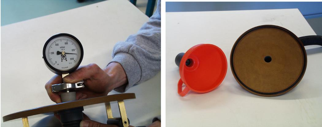
Abb.16: Unterdruck eines Industriestaubsaugers (a) sowie verschieden grosse Dichtflächen am Schlauchende des Staubsaugers (b).
