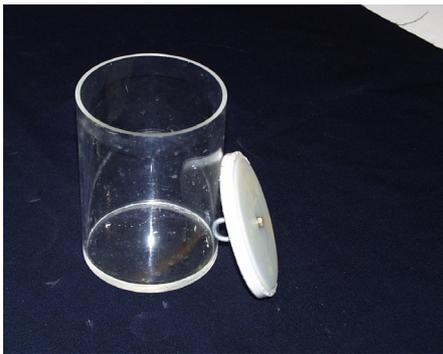
Abb.20: zylindrisches Plexiglasgefäss mit stabilem Deckel und Haken für das Anbringen von Gewichten in der Achse.
