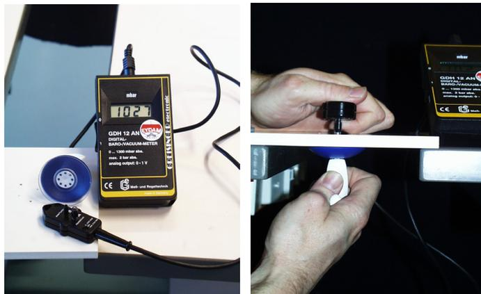
Abb.15: Prinzip der Druckmessung beim Hebelsauger
