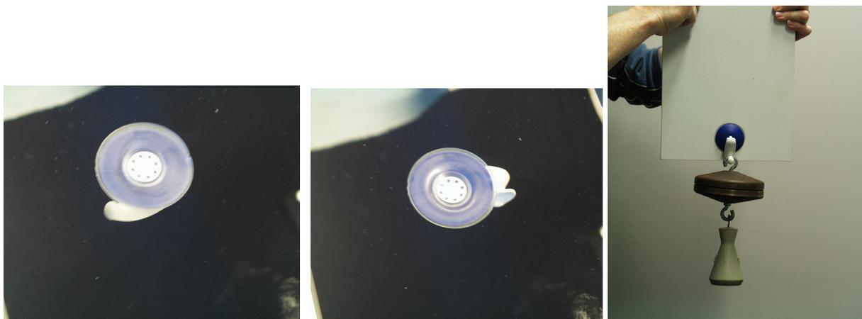
Abb.14: Angepresster Hebelhaken vor (a) bzw. nach (b) Umlegen des Hebels, durch eine Glasplatte gesehen. Der Haken kann eine Masse von 5 kg parallel zur Saugfläche tragen (c).
