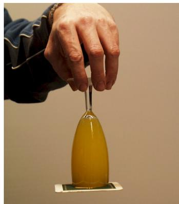
Abb.19: Experiment zum umgedrehten Wasserglas: der Bierdeckel wird durch den Luftdruck an das Glas gepresst: es läuft keine Flüssigkeit aus.
