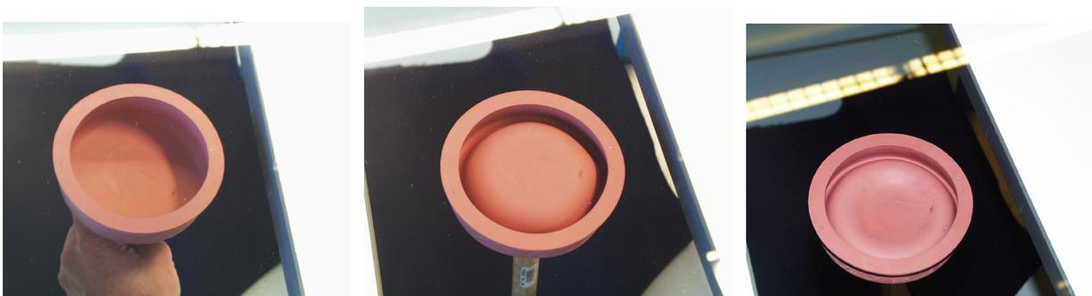
Abb.8: Ausgussreiniger auf einer Glasplatte vor dem Anpressen (a) sowie nach dem Anpressen ohne (b) bzw. mit zusätzlicher Belastung (c).
