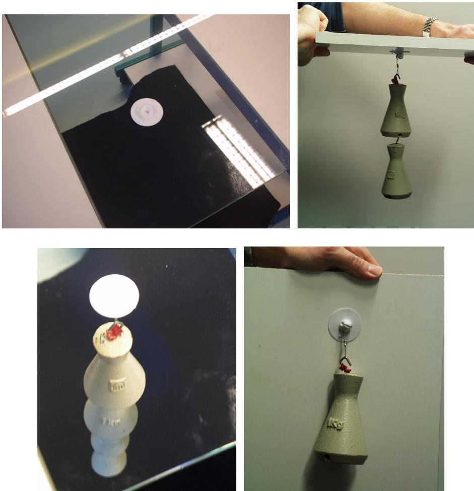
Abb. 12: a: Angepresster Haken durch eine Glasscheibe beobachtet. Man erkennt die Begrenzung des inneren Volumens. Haken bei Belastung mit 2kg von der Seite (b) bzw. mit 3kg von oben durch eine Glasscheibe gesehen (c) sowie Belastung parallel zur Saugfläche (d)
