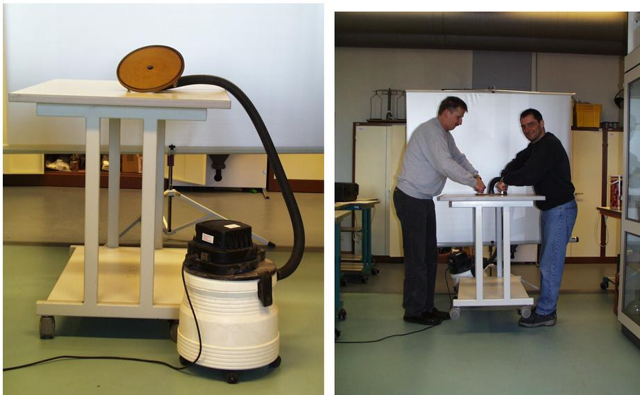
Abb.17: Aufbau zum Heben grosser Gewichte mit einem Staubsauger (a) sowie Durchführung eines Versuchs: Heben eines 38 kg schweren Tisches (b)
