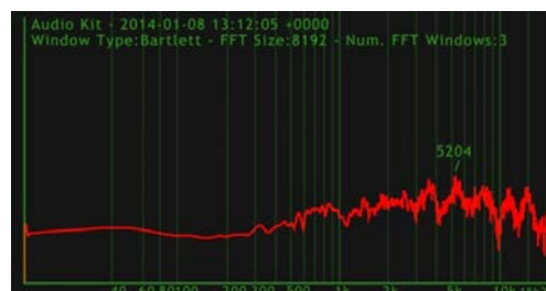
Abb. 22: Frequenzspektrum des weißen Rauschens ohne Resonanzröhre, aufgenommen mit Audio Kit
