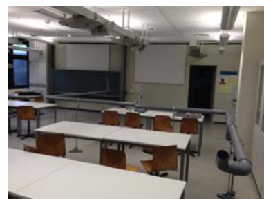
Abb. 18: Aus zusammensteckbaren Wasserrohren aufgebautes Schallrohr
