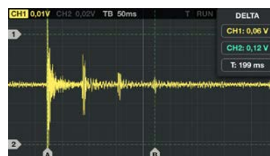
Abb. 19: Messung der Rohrlänge mit der App „Oszilloskop“ [25]
