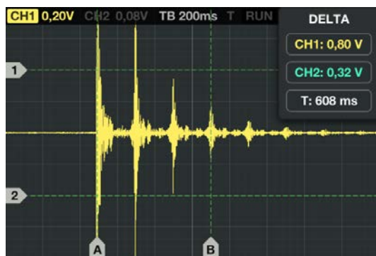
Abb. 17: Screenshot der App „Oszilloskop“; der erste Ausschlag repräsentiert das originäre Klopfgeräusch, die weiteren werden von den aufeinanderfolgenden Echos verursacht.
