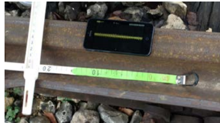
Abb. 26: Messung der Schallgeschwindigkeit in Eisen mittels Bahngleis und Smartphone
