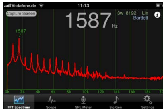
Abb. 7: Frequenzspektrum des Klangs einer Blockflöte, dargestellt mit Audio Kit
