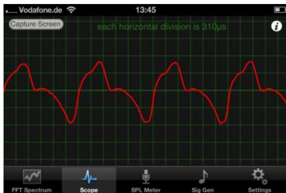
Abb. 6: Oszillogramm des Klangs einer Blockflöte, dargestellt mit Audio Kit
