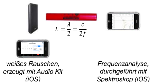
Abb. 14: Versuchsaufbau zur experimentellen Bestimmung der Mündungskorrektur
