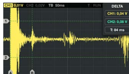
Abb. 27: Der sich über die Luft ausbreitende Schall erreicht das Smartphone aufgrund der geringeren Schallgeschwindigkeit mit einer messbaren Verzögerung gegenüber dem Signal, das sich im Gleis fortpflanzte.
