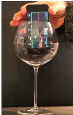
Abb. 24: Verwendung eines Rotweinglases als Helmholtz-Resonator
