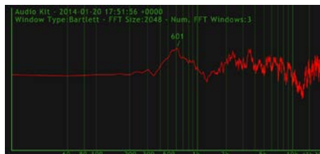
Abb. 25: Die Resonanzfrequenz des verwendeten Rotweinglases beträgt 601 Hz, aufgenommen mit Audio Kit
