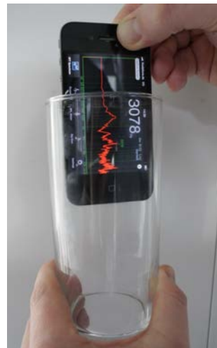
Abb. 21: Versuchsaufbau zur Bestimmung der Schallgeschwindigkeit mit einem Pfälzer Schoppenglas
