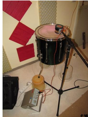
Abb. 10: Versuchsaufbau für Klangfiguren auf dem Trommelfell
